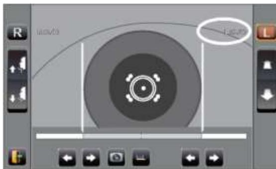
**9** Нажатием кнопок **R** или **L** передвинуть измерительную головку ко второму глазу и провести его измерения аналогичным образом.
