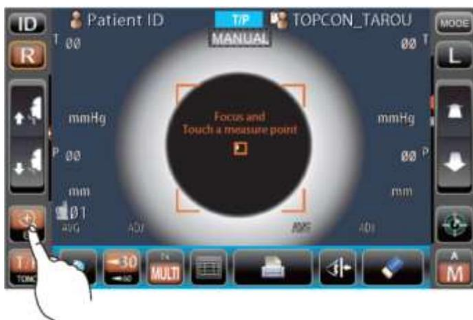
**4** Нажать кнопку **Measuring head forward/backward**. На роговице будет отражаться размытая точка для выравнивания.
