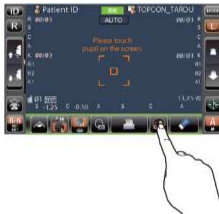
3 Отображается экран измерения диаметра роговицы и линия позиционирования.
