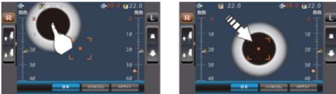
**5** С помощью кнопки Measuring head forward/backward (Перемещение измерительной головки вперед/назад) отрегулировать положение иконки, обозначающей положение по оси Z, для правого/левого глаза.
